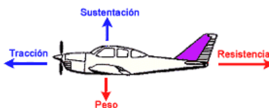
Fig.1.3.1 - Fuerzas que actúan en vuelo.
